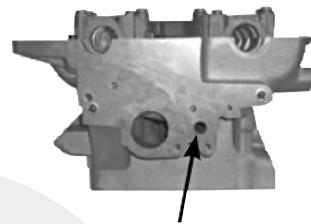
Con 4 fori per sistema anti inquinamento e foro per valvola di ritorno dei gas di scarico
