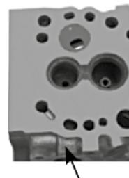
Scanalatura per lubrificazione albero a cammes /
