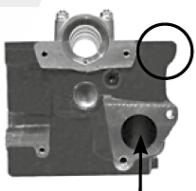
Scarico valvole di guida altezza 9,5 mm
