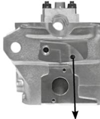
Foro dell'acqua Ø 8 mm / Water hole Ø 8 mm
