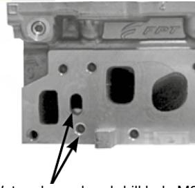
Canale di acqua e foro M8 / Water channel and drill hole M8
