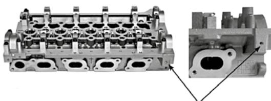
1 foro frontale collettore di scarico. Foro iniettore Ø 22 mm
