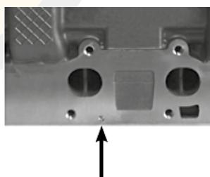
1 foro di 5mm di diametro sul lato collettore di scarico
