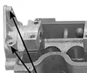
Due fori nella pompa a vuoto / Two drill holes in the vacuum pump
