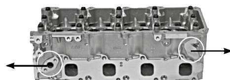
Con uscita per la pompa dell'acqua
