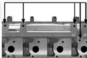
5 fori di 8 mm di diametro sul lato collettore
