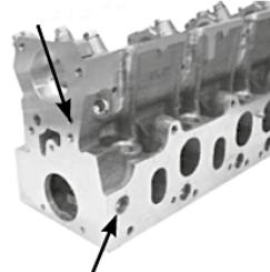
Foro di lubrificazione Ø 6 mm - Termo contatto M 14 x 1,25 /
