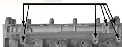
6 fori di 8 mm di diametro sul lato collettore
