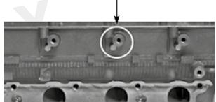
Con sensore albero a cammes / Withcamshaft sensor
