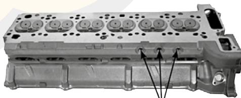
3 fori di uscita dell'acqua / 3 water outlet holes
