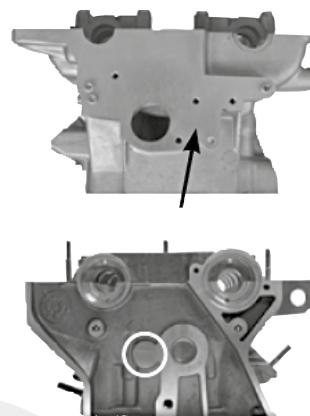
Senza fori per sistema anti inquinamento e senza foro per valvola di ritorno dei gas di scarico
