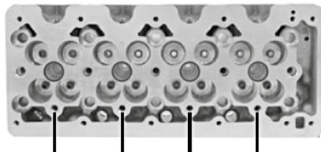
4 fori 10x1,5 per fissare l'injectore
