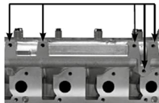
5 fori di 8 mm di diametro sul lato collettore
