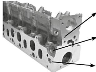
Foro di lubrificazione Ø 6 mm - Canale dell'acqua - Termo contatto M 14 x 1,25
