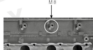
Con sensore albero a cammes / With camshaft sensor
