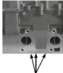
3 fori di 5mm di diametro sul lato collettore di scarico / 3 holes 5 mm diameter on exhaust manifold side
